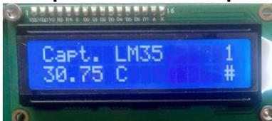
**Test du capteur LM35 :** Toucher le capteur pour faire varier la température. Pour quitter ce test, appuyer sur la touche "#".
