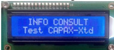
Au démarrage, affichage de l'écran d'accueil. Faire tourner le potentiomètre P1 (en haut, à côté de l'afficheur) pour régler l'intensité lumineuse de l'afficheur.
