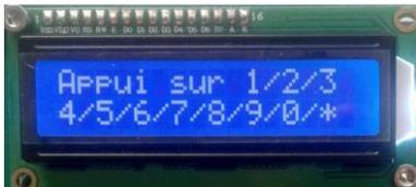
Affichage de l'écran choix des fonctions : appuyer sur l'une des touches du clavier pour tester les différents capteurs-actionneur de la carte CAPAX-Xtd® selon le tableau ci-dessous.
