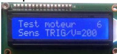
**Test du moteur :** le moteur tourne dans les deux sens (Horaire ou Trigonométrique) et à des vitesses différentes. Ce test s'arrête automatiquement sans appui sur la touche "#".
